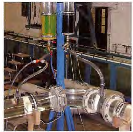
Abb. 3: Teilansicht des Modells im Hubert-Engels-Labor mit Dosierungen
