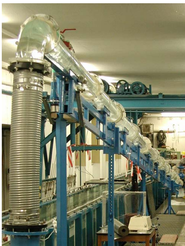
Abbildung 3 Modell einer Freigefälledruckleitung im Hubert-Engels-Labor
