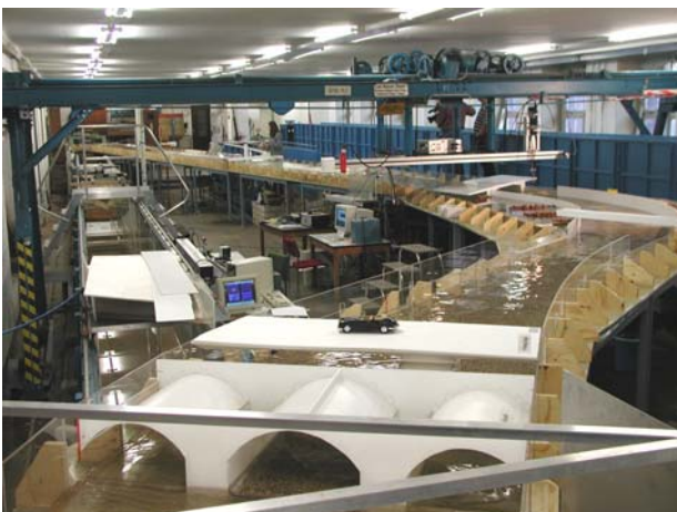
Bild 2: Physikalisches Modell „Weißeritzknick“
