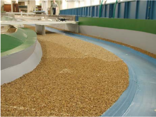
Bild 3: Modell der Planungsvariante der Stadt Dresden mit Brücke Löbtauer Strasse
