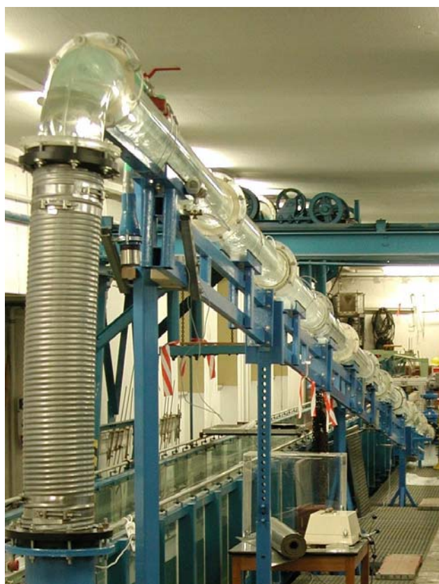
Abbildung 3 Modell einer Freigefälledruckleitung im Hubert-Engels-Labor
