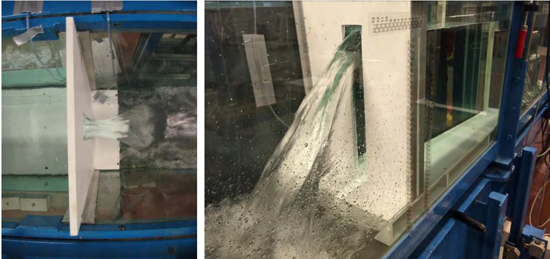
Abbildung 5: Schlitzpass, frei austretenden Strahl am physikalischen Modell (rechts) mit sichtbarer Strahleinschnürung in der Draufsicht (links)
