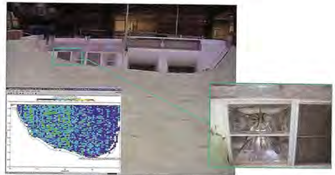
Abb. 3: Nachbau des Kraftwerkes im hydraulischen Labor (links unten) – Feldaufnahme eines Zulaufprofils mittels ADCP
