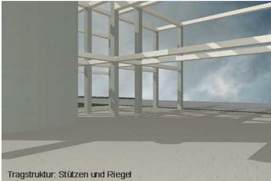
Abb. 5-103: Die reine Tragstruktur, bestehend aus Stützen und Riegeln
